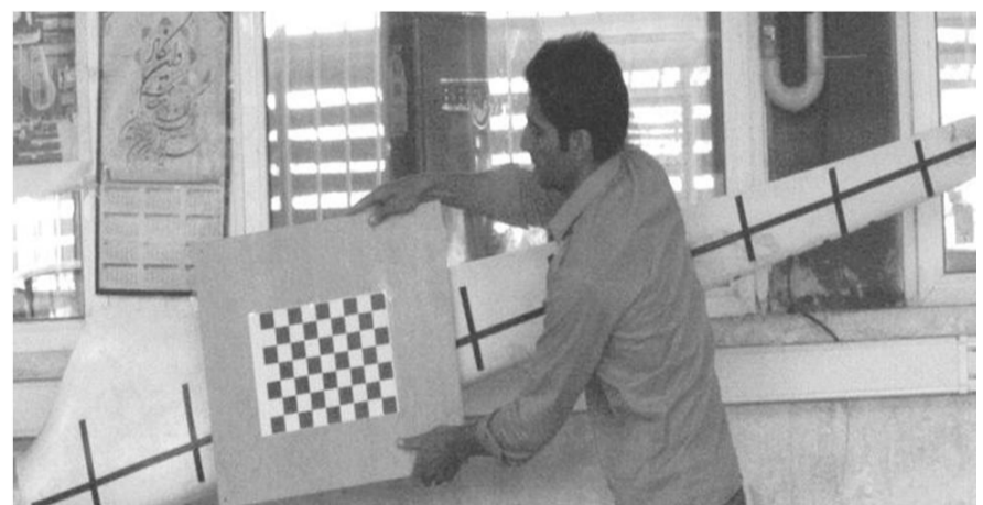
Fig. 7 Targeted plane placed on the wind turbine blade body شکل 7 صفحه هدف قرار داده شده روی بدنه پره توربین بادی
