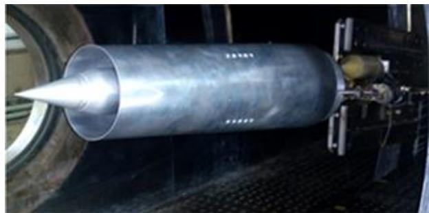
شکل ۲ تصویر مدل نصب شده در تونل باد
