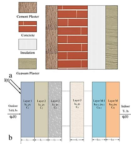
شکل 1 (الف) نمایی از دیوار در نظر گرفته شده و (ب) مدل دیوار چندلایه و شرایط مرزی آن
