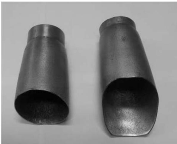
شکل ۹ لوله متورم شده و لوله با سطح مقطع مربعی تولید شده به وسیله قالب انعطاف پذیر
