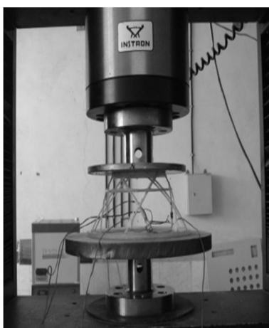
شکل 12 آزمایش فشار محوری پوسته مشبک مخروطی
