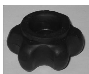
شکل ۳۰ قطعه تولید شده در ۸۵٪ کورس جابه‌جایی توسط
