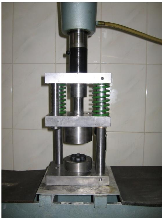
شکل ۲۷ قطعه نهایی داخل حفره قالب پس از تغییر شکل زیر
