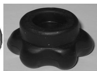
شکل ۲۹ قطعه تولید شده در ۶۵٪ کورس جابه‌جایی توسط
