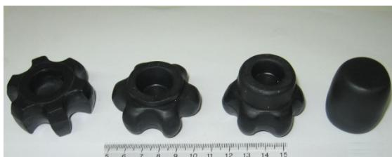
شکل ۲۸ نحوه شکل گیری قطعه گردوبی در کورس‌های
