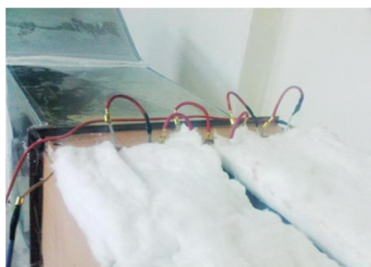
شکل 3 سطح شار ثابت با عایق پشم سنگ
