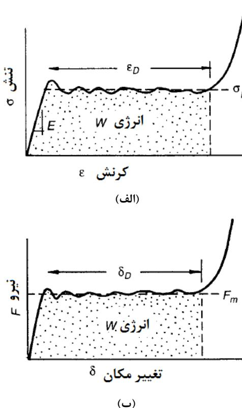
شکل ۱ منحنی الف- تنش- کرنش و ب- نیرو- جابجایی فوم فلزی
