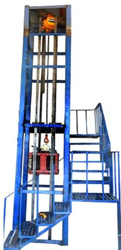
شکل 1 دستگاه چکش پرتابه‌ای
