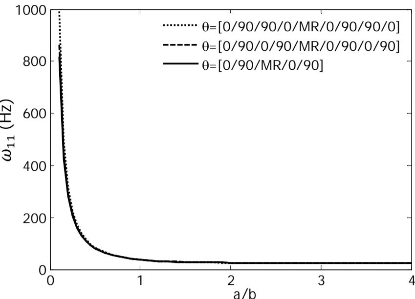
**شکل ۱۰** اثر نسبت منظری ورق ( $a/b$ ) بر فرکانس مود نخست در شدت میدان مغناطیسی 300 گاوس
