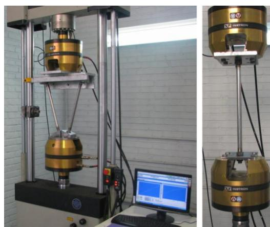
شکل ۱ دستگاه سروهیدرولیک اینسترtron ۸۸۰۲
