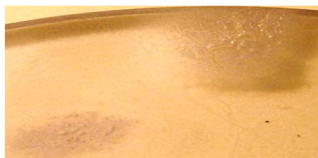
شکل ۱۱ نمونه‌ای از آسیب‌های سطحی پس از بازپخت
