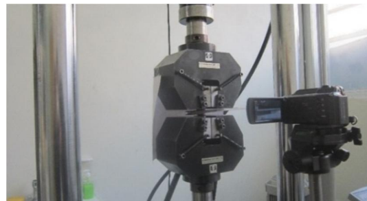
شکل 3 آزمون خستگی رشد جدایش بین لایه‌های، تحت بارگذاری مود I
