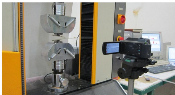
شکل 2 آزمون شبه‌استاتیکی رشد جدایش بین لایه‌ای، تحت بارگذاری مود ا
