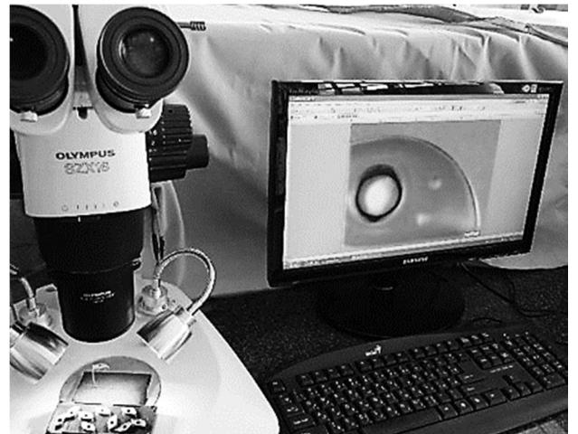
شکل ۳ چیدمان اندازه‌گیری سایش ابزار با استفاده از میکروسکوپ نوری SZX16
