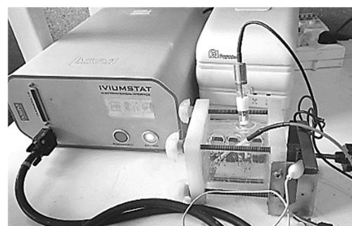
شکل 5 نحوه اندازه‌گیری مقاومت به خوردگی الکتروشیمیابی سطوح فرزکاری شده
