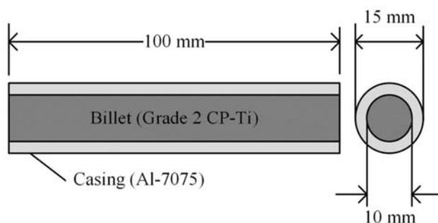
شکل 1 شکل شماتیک و ابعاد نمونه‌ی دوفلزی برای ECAP.
