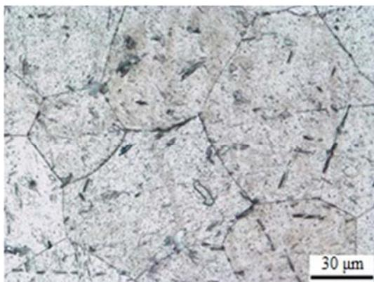
شکل 2 میکروساختار CP-Ti بعد از آنیل بدست آمده از میکروسکوپ نوری.
