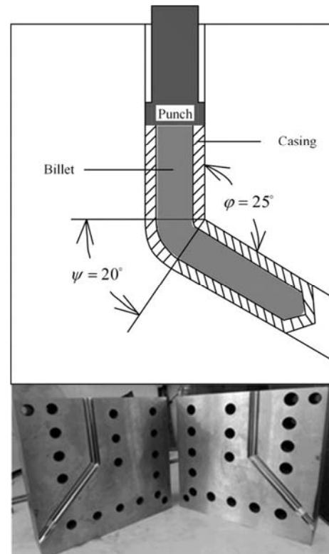
شکل ۳ شکل شماتیک و حقیقی از قالب ECAP با نمونه‌ی دوفلزی.
