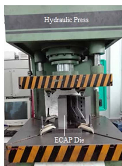
شکل ۴ پیکربندی پرس هیدرولیک و قالب ECAP.
