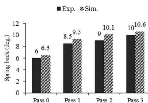
**شکل 17** اثر گذرهای ECAP بر میزان برگشت فنری نمونه‌های تیتانیم خالص تجاری در آزمون خمکاری سه نقطه‌ای.
