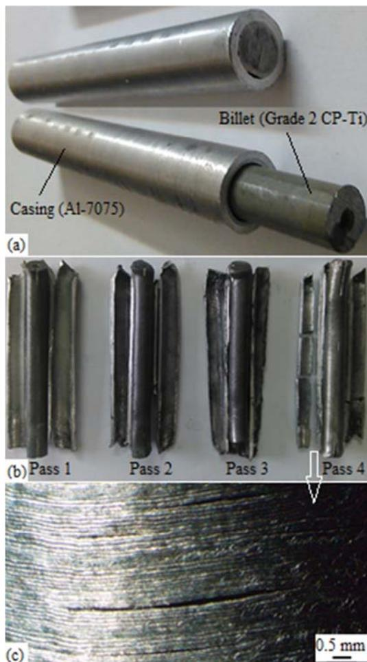
شکل ۵ نمونه‌های دوفلزی، (a) قبل از فرایند ECAP، (b) بعد از فرایند ECAP، (c) تصویر مکروسکوپیک نوری از ترک‌های سطحی بعد از گذر چهارم ECAP.
