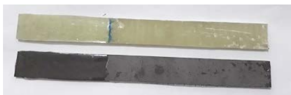
شکل (۱۰) سطوح شکست چندلایه کامپوزیتی و زیر لایه فولادی نمونه یک‌سرگیردار دولبه متقارن
