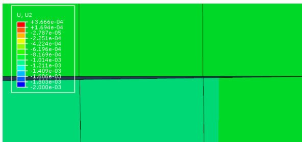
شکل ۱۶ بازشدن نوک ترک برای نمونه یک‌سرگیردار دولبه نامتقارن
