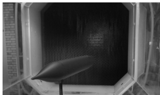
شکل ۴ نحوه قرار گیری مدل زیرسطحی در اتاق آزمون تونل باد برای انجام آزمایش‌های مرئی‌سازی با روغن
