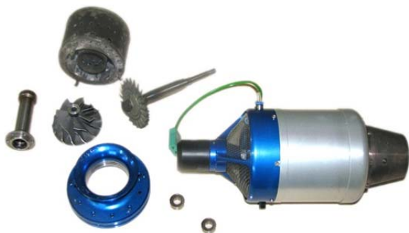
شکل ۲) موتور میکروتوربوجت رن ۱۰۰ و اجزای آن
