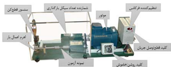
شکل ۴) دستگاه آزمون خستگی پرچرخه دورانی خمشی
