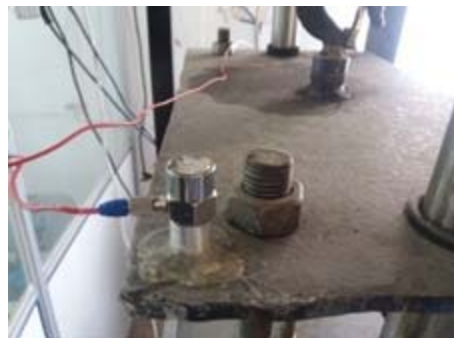
شکل ۴) موقعیت شتاب‌سنج روی دستگاه آزمایش
