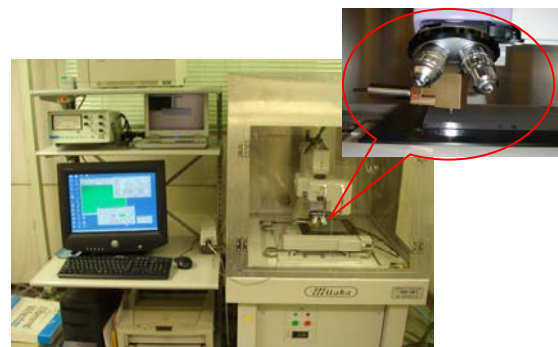
شکل ۵ نصب پروب خازنی به‌جای عدسی شیئی میکروسکوپ اندازه‌گیری غیرتماسی لیزری
