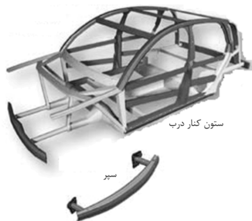
شکل ۲ برخی از قطعات خودرو که دارای سطح مقطع متغیر می‌باشند [۳]
