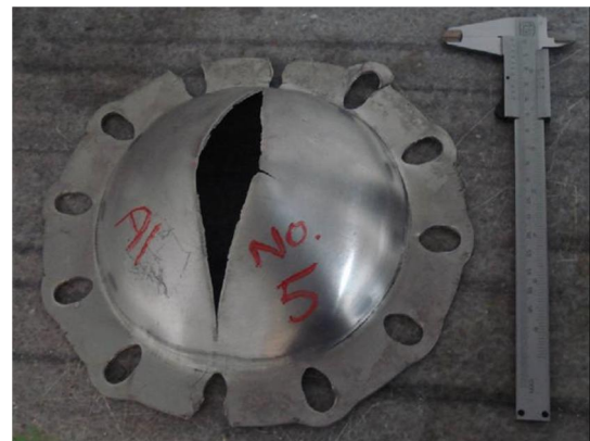
شکل 10 حالت واماندگی III (تغییر شکل پلاستیک با پارگی موضعی در مرکز ورق)
