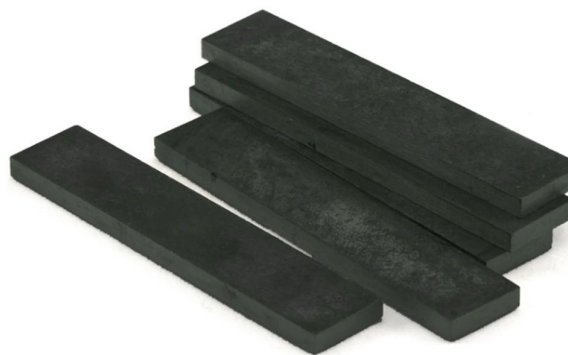
Fig. 6 the molded samples of PP/AGO nanocomposites شکل 6 نمونه قالب‌گیری شده نانوکامپوزیت پلی پروپیلن / اکسید گرافن آلکیل‌دار شده
