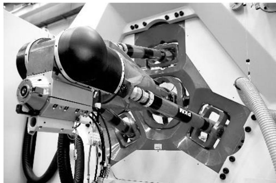
شکل 1 ربات جوشکار لیزر تری‌سپت محصول شرکت تری‌سپت پی‌کی‌ام [16]
