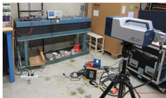
شکل ۱۰ دستگاه اندازه گیری جابجایی پیچشی ترانسدیوسر
