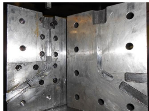
شکل 3 قالب ECAP مورد استفاده با ابعاد کانال 10 \times 10 \text{ mm}^2 و زاویه کانال و گوشه 120 و 20 درجه
