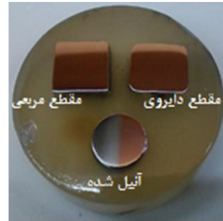
شکل 6 نمونه‌های مانده ماده اولیه آبیل شده و مقطع مربعی و دایروی ECAP شده
