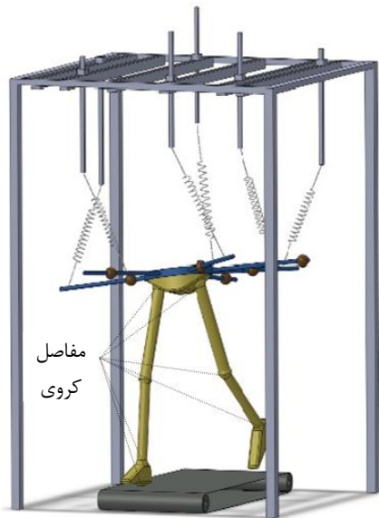
شکل ۳ نمای سه بعدی مدل دینامیکی پایین تنه کاربر بیمار همراه با آرتز لگنی و چارچوب در حین راه رفتن بر تردمیل
