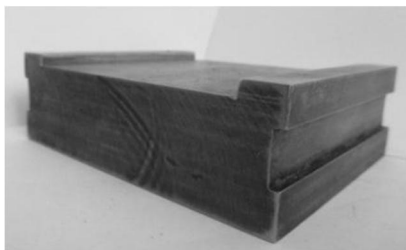
Fig. 3 The flattened die
