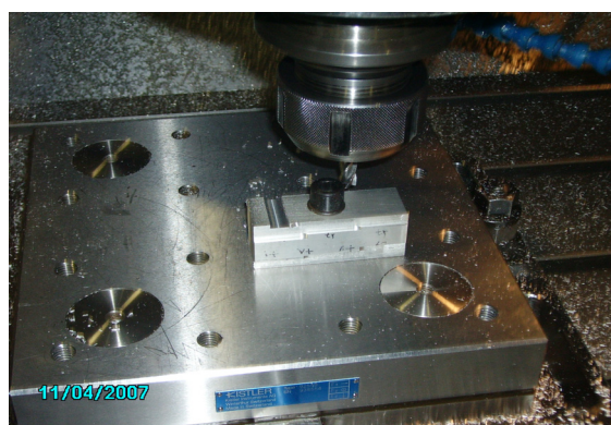
شکل ۵ قطعه کار، دینامومتر و ابزار در حال شیار تراشی
