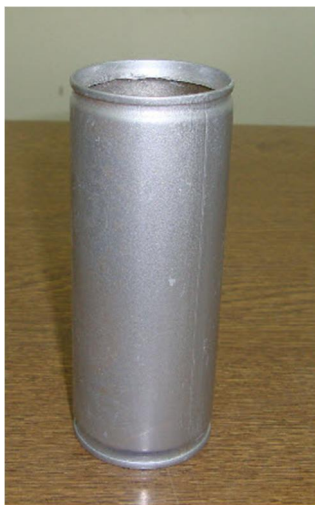
شکل 2 نمای جاذب لوله‌ای با برش دایره‌ای روی سرپوش
