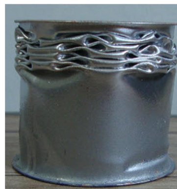
شکل 6 شکل چین‌خوردگی بالایی لوله
