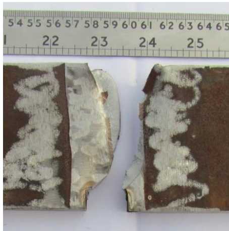
Fig.8 Details of fracture path on the top view of fractured specimen شکل 8 جزئیات مسیر رشد ترک در نمای فوقانی نمونه شکسته شده ضربه سقوطی
