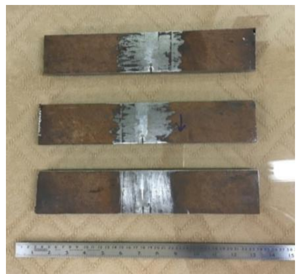
Fig. 4 The DWTT specimens with spiral seam weld of API X65 steel شکل 4 نمونه‌های آزمایشگاهی ضربه سقوطی حاوی درزجوش مارپیچ از جنس فولاد API X65 با شیار ماشین‌کاری شده
