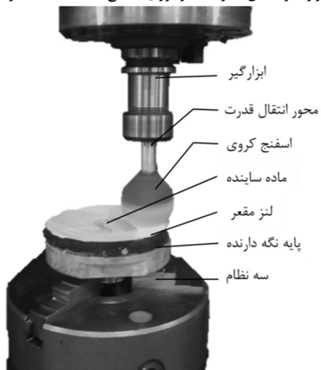
شکل 10 فرایند پرداخت با ابزار کروی
