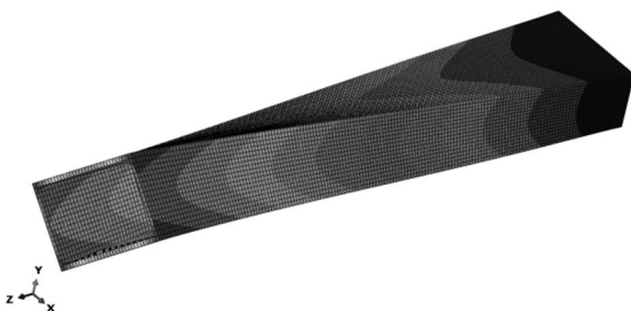
شکل آ-3 مدل سه بعدی تیر قوطی کامپوزیت در آباکوس
