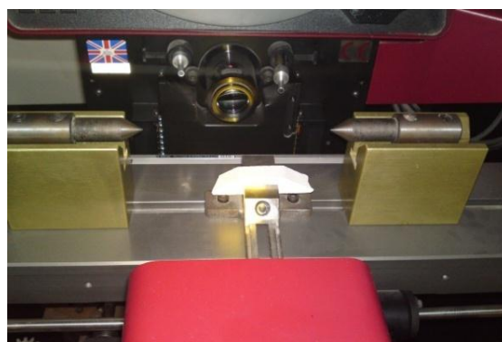
شکل ۸ دستگاه پروفایل پروژکتور در حال اندازه‌گیری
