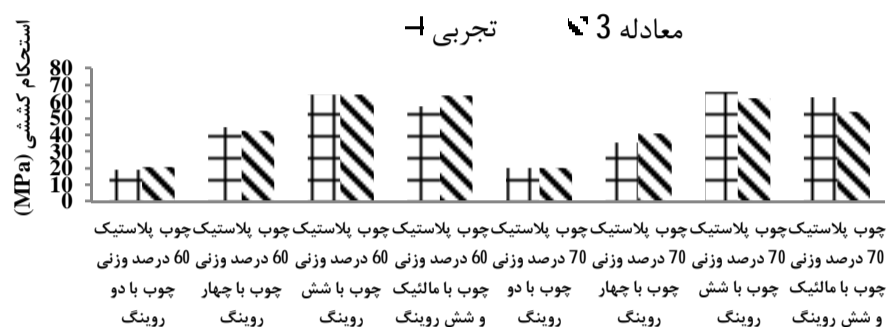
شکل 11 مقایسه بین استحکام نهایی کششی کامپوزیتهای هیبریدی از نتایج تجربی و تئوری (کسر حجمی الیاف کوچکتر از کسر حجمی بحرانی الیاف)
