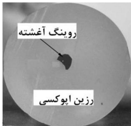
شکل 6 تصویری از سطح مقطع روینگ آغشته شده
