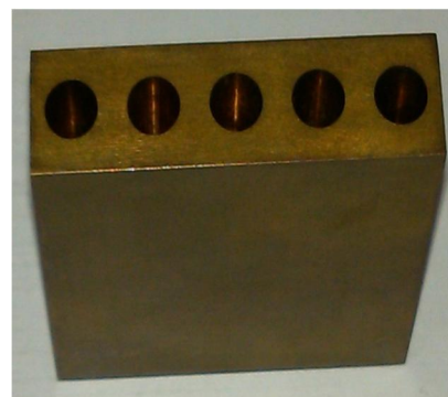
شکل 3 محل قرارگیری گرمکن‌های فشنگی در زیر میکروکانال
