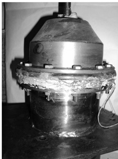
شکل 5 دسته موتور مگنتورئولوژیکال ساخته شده
