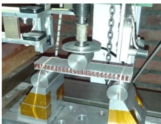
شکل 2 تیر ساندویچی تحت بارگذاری ضربه سرعت پایین
