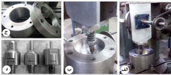
شکل 2 نمایی از فرایند کار تجربی، الف) ابزار ضربه زنده، ب) کلمپ ورق و نمونه فرم یافته، ج) سیستم کلمپ، د) قطره‌های مختلف پانچ.
