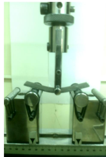
شکل 8 یک نمونه از آزمایش خمش سه نقطه
