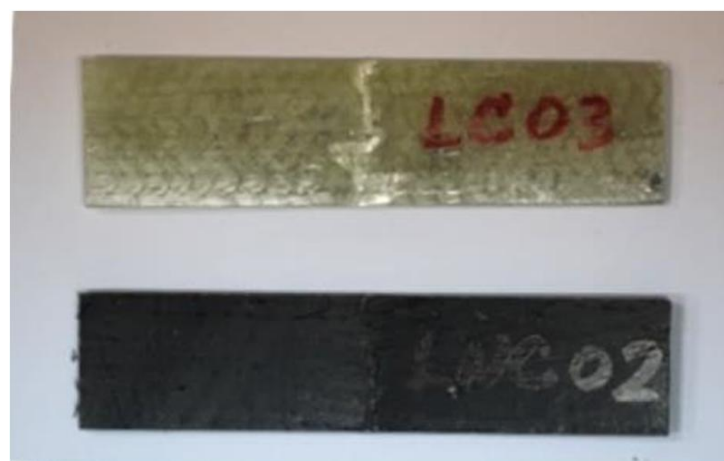
شکل 18 نمونه‌های خمشی پس از آزمایش
