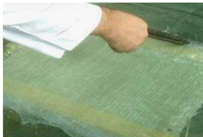
شکل 6 صفحه کامپوزیت لایه‌ای ساخته شده به روش چیدمان دستی
