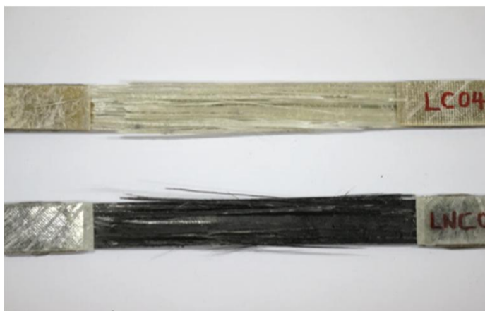
شکل 10 نمونه‌های کششی در راستای الیاف کامپوزیت لایه‌ای شیشه/اپوکسی و نانوکامپوزیت شیشه/نانولوله/اپوکسی پس از آزمایش
