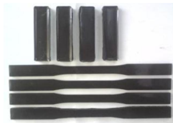
شکل 5 نمونه‌های استفاده شده برای انجام آزمایش‌های مکانیکی نانوکامپوزیت
