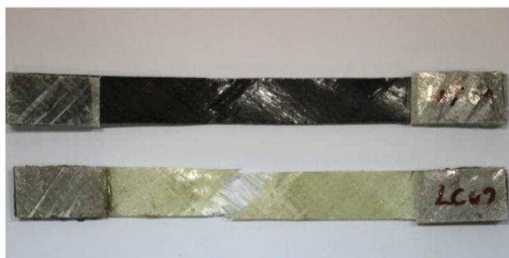
شکل 22 نمونه‌های آزمایش برش داخل صفحه‌ای کامپوزیت لایه‌ای شیشه/اپوکسی و نانوکامپوزیت شیشه/نانولوله/اپوکسی
