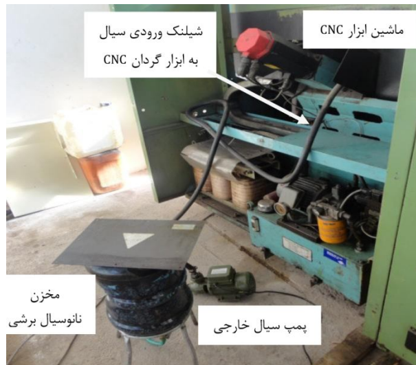
شکل ۱ تصویر شماتیک و واقعی سامانه تأمین نانوسیال برشی در حین عملیات تراش کاری
