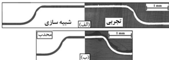
شکل 15 مقایسه نتایج تجربی و شبیه‌سازی توزیع ضخامت و عمق شکل داده شده نمونه‌ها در فشار 80 مگاپاسگال و در راستای الف) طولی، ب) عرضی
