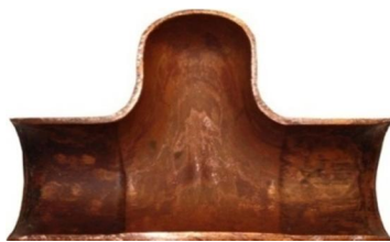
شکل 15 قطعہ سهرای T شکل آزمایش هیدروفرمینگ پالسی
