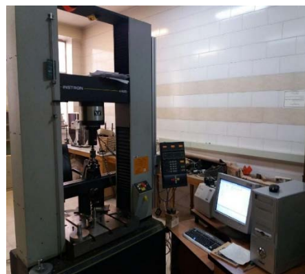
شکل (۴) دستگاه اینسترون مدل ۴۴۸۶
