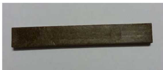
شکل (۳) نمونه آزمون خمش مطابق با آیین‌نامه ASTM D790
