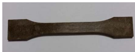
شکل (۲) نمونه آزمون کشش مطابق با آیین‌نامه ASTM D638
