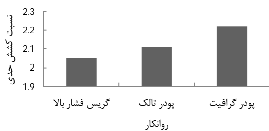
شکل 9 نسبت‌های کشش حدی به دست آمده در دمای 150^{\circ}\text{C}
