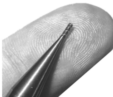
شکل 1 ابزار میکروفرز بکار رفته در آزمایش‌ها
