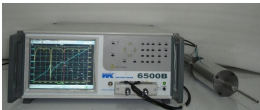
شکل 2 اندازه‌گیری فرکانس رزونانس ترانسدیوسر
