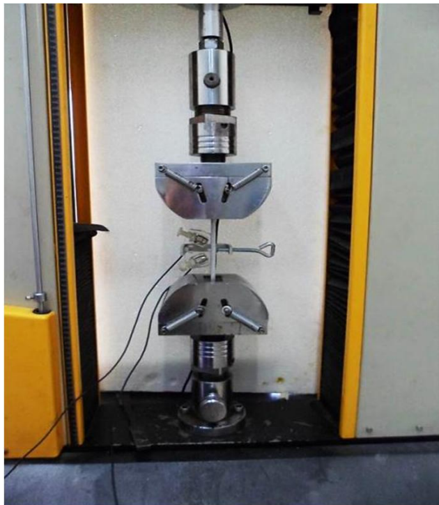
شکل 7 اندازه گیری ضریب آکستوالاستیک
