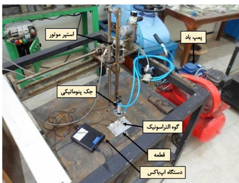
شکل 6 تجهیزات مورد استفاده در روش التراسونیک
