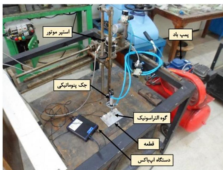
شکل 6 تجهیزات مورد استفاده در روش ترانسونیک
